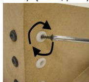
element wkładamy wkręty i wkręcamy je,
